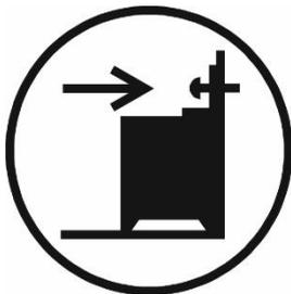
**ATTENZIONE:** Per evitare l'oscillazione o il ribaltamento dell'apparecchio è necessario sistemare gli stabilizzatori. Seguite le istruzioni per la loro sistemazione.
