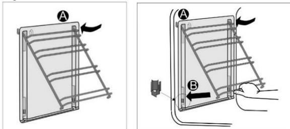
Posizionare le griglie con inserti catalitici sulle aperture superiori nelle pareti laterali del forno "A". Spingerle nelle orecchiette flessibili nella parte inferiore del forno "B".
