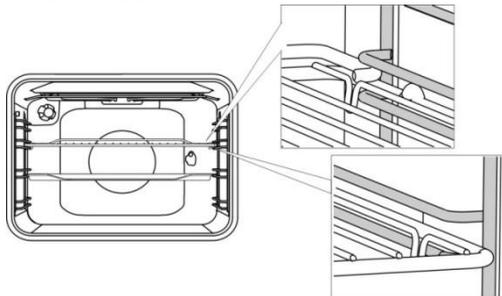
Con le guide telescopiche abbiate cura di estrarre le guide di un livello sul quale appoggiate la griglia o le teglie per spingerle poi all'interno fino in fondo.
