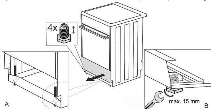
B) L'altezza della cucina è di 900 mm. Varia a seconda del modello, l'altezza dell'apparecchio può essere regolata tra gli 850 e i 920 mm o tra gli 900 e i 920 mm (varia a seconda del modello).
