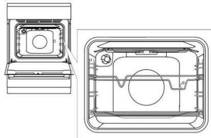
Il supporto del girarrosto va inserito nel terzo livello dal di sotto, nel primo livello va posta una teglia profonda per la raccolta del gocciolato.
