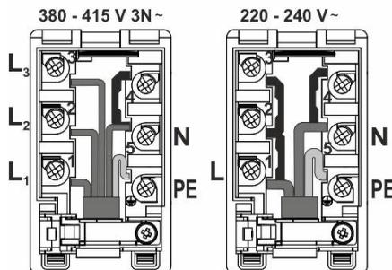
Si raccomanda il collegamento a trifase tramite il cavo di collegamento del tipo H05VV-F5G1,5 (codice precedente CGLG 5Cx1,5), (fusibile 3x16 A).
