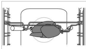
La carne va infilata sulle forchette e le viti fissate. Il manico delle forchette va appoggiato sul supporto anteriore, mentre la parte finale va infilata nell'apertura sulla parte destra della parete posteriore del forno (la fessura è protetta da un coperchio girevole). A questo punto svitate il manico dello spiedo e chiudete l'anta.
