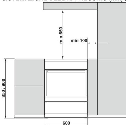
Le pareti più vicine all'apparecchio e gli elementi dell'arredamento (come pavimento, le pareti della cucina sia laterali che posteriori) devono essere resistenti a un livello di temperatura non inferiore a 90°C.
